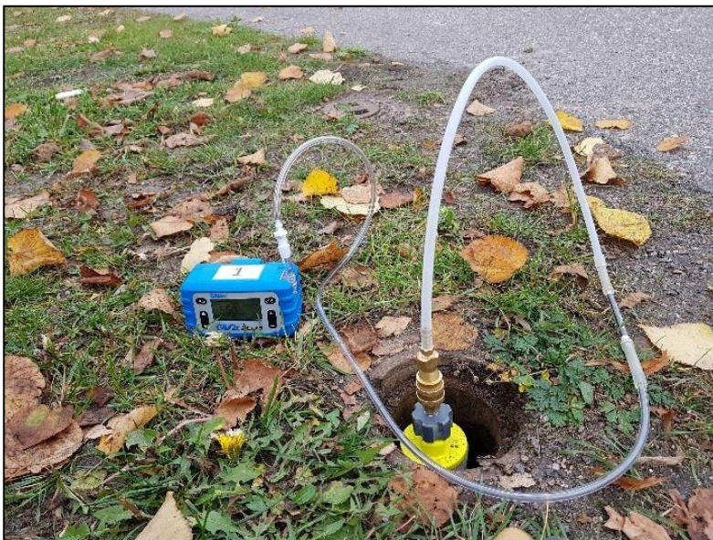
Kuva 2. Esimerkki huokosilmanäytteenotossa käytettävästä pumpusta ja korkista.
